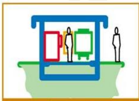
(ب) پست پیش‌ساخته کمپکت قابل تردد
