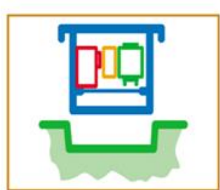
شکل (۱۲): نمونه‌ای از پست پیش‌ساخته کمپکت بدون نیاز به احداث فونداسیون در محل
