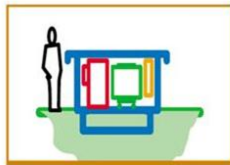
(الف) پست پیش‌ساخته کمپکت غیر قابل تردد
